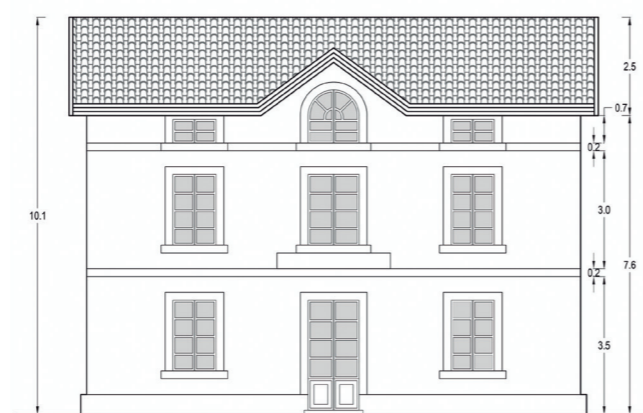
Fig 04. Alçado Frontal da Estação Modelo-Tipo: 4.º Classe (Alves, 2015: 602; redesenhado pelos autores).
