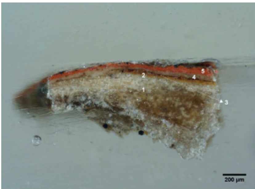
Fig. 04. Corte estratigráfico da amostra de repinte vermelho (40x): 1) preparação; 2) policromia; 3) policromia (?); 4) preparação; 5) repinte.
