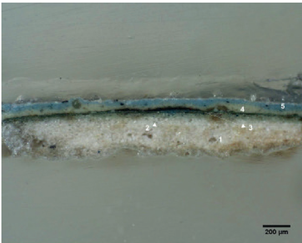
Fig. 03. Corte estratigráfico da amostra de repinte azul da túnica (40x): 1) preparação; 2) policromia; 3) sujidade (?); 4) preparação; 5) repinte.
